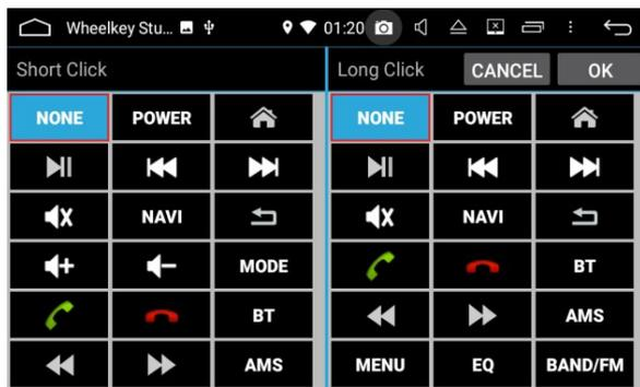
Entrez dans l'interface de réglage pour sélectionner l'apprentissage de la touche, « réinitialisation de la commande du volant » tout d'abord, puis appuyez longuement sur le bouton sur le volant, sélectionnez les touches correspondantes dans l'interface. Lorsque le réglage est réussi, les boutons correspondants de l'interface s'allument.
